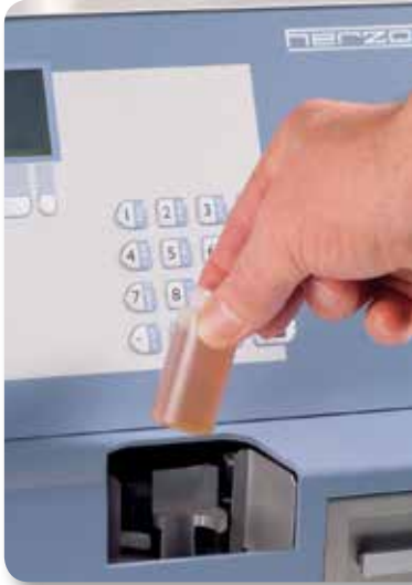
1. 将样品杯放入进样口
